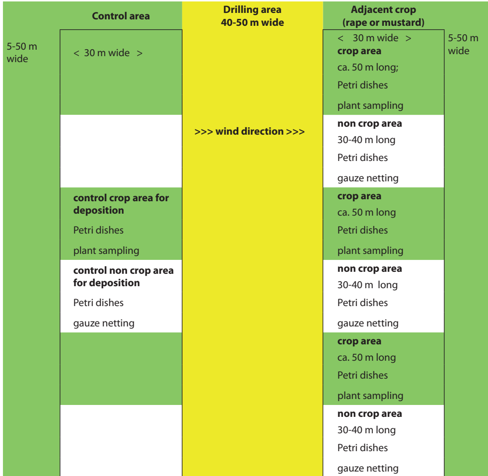
Fig. 2 Schematic plan for drift experiments with replicated adjacent crop and non crop areas, used 2009-2012. Abb. 2 Schematischer Plan der JKI Abdrift-Versuche mit wiederholten Nachbarkulturen und offenen Bereichen ohne Kultur für 2009 bis 2012.
